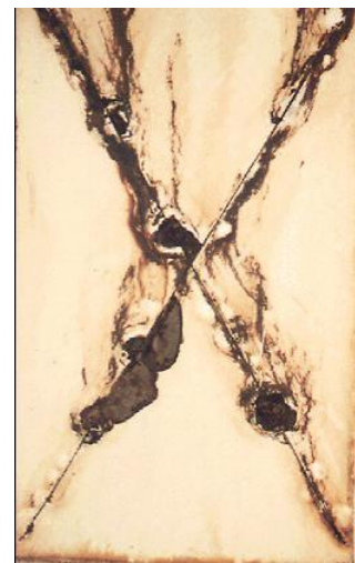
Figur 3: Billedet til højre viser resultatet af en underfilmskorrosion. Billedet viser en plade coatet med traditionel våd epoxy maling. Efter coatingen er der ridset et kryds i pladen og den er herefter placeret i et lukket kammer med høj fugtighed og saltvand.
