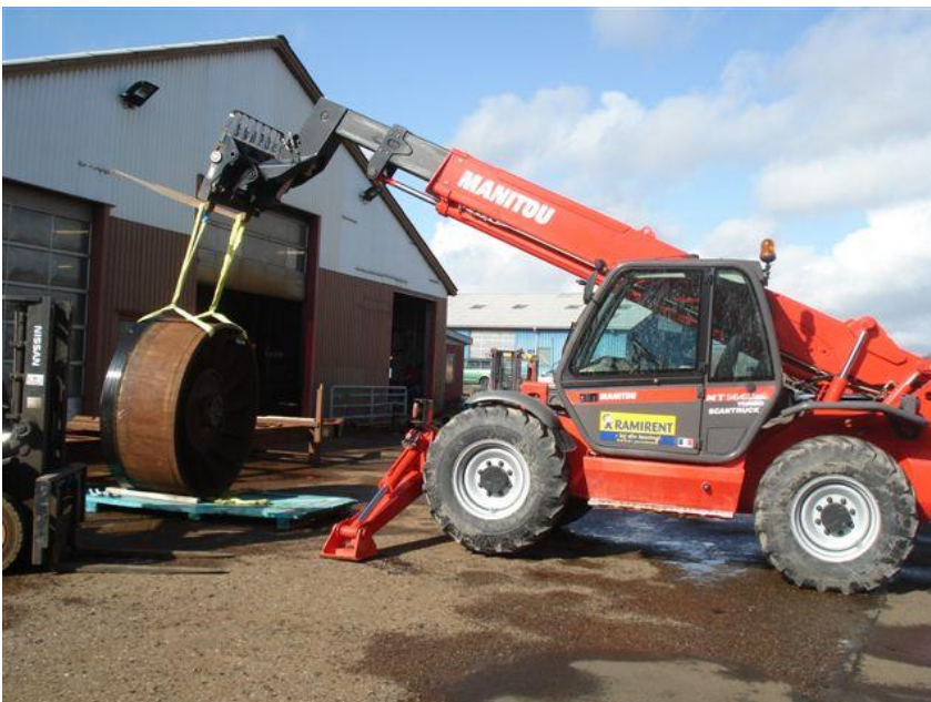
Billede 1: Der er tale om meget tunge emner, når det er en hovedkølevandspumpe til et kraftværk. Den enkelte del vejer op til 3,5 tons. Det kræver særligt udstyr at håndtere de store emner, som er på op til 2 meter i diameter.
