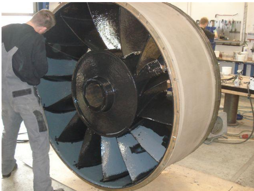
Billede 4: Alle rengjorte og rugjorte overflader på pumpedelen belægges med to lag komposit armeret med keramik, som efterfølgende kan modstå erosion fra sand og partikler i det saltvand, der efterfølgende skal flyde igennem pumpen.
