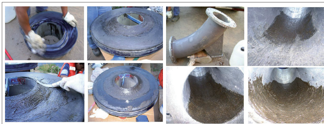
FLX-D belagt på pumpepedel, i albue og på sliddel til maskine
