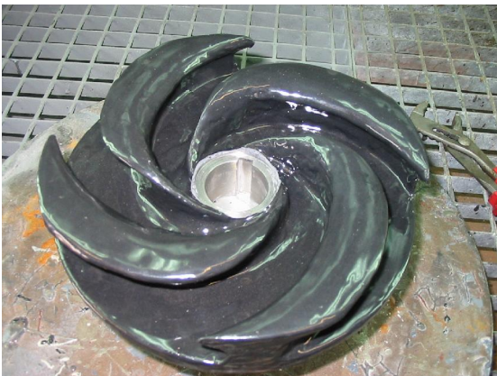
Billede 1: Et løbehjul til en spildevandspumpe belagt med komposit. Bemærk den glatte overflade, som forbliver glat selv efter den korrosive og slidende belastning fra spildevandet. Det skyldes at kompositmaterialet er armeret med keramik og at binderen er en særlig stærk epoxy.
